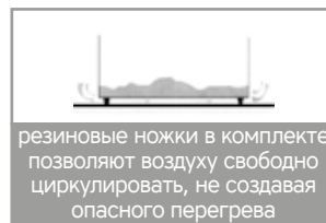
вариант крепления греющего коврика
