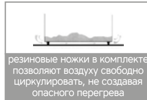
вариант крепления греющего коврика
